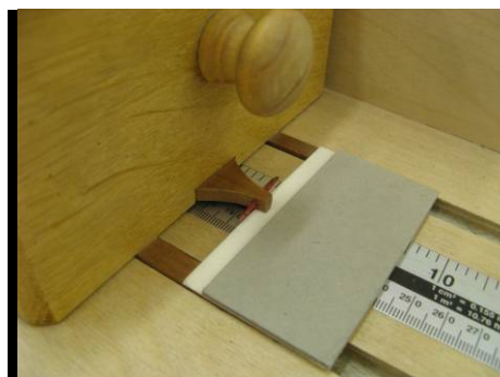
Partes del medidor: inicio de la regla en la esquina y tope del mismo.
