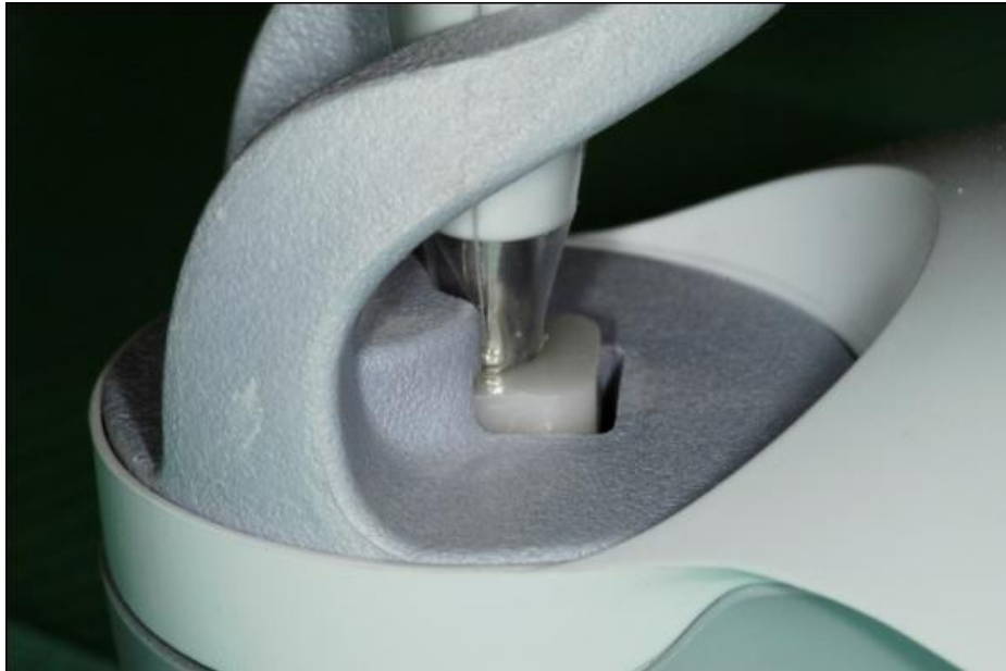
Figura 4. Calibración del espectrofotómetro
