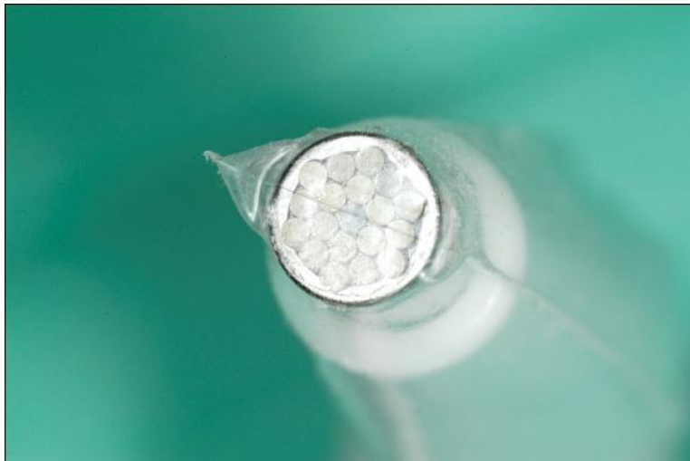
Figura 6. Punta lectora del espectrofotómetro
