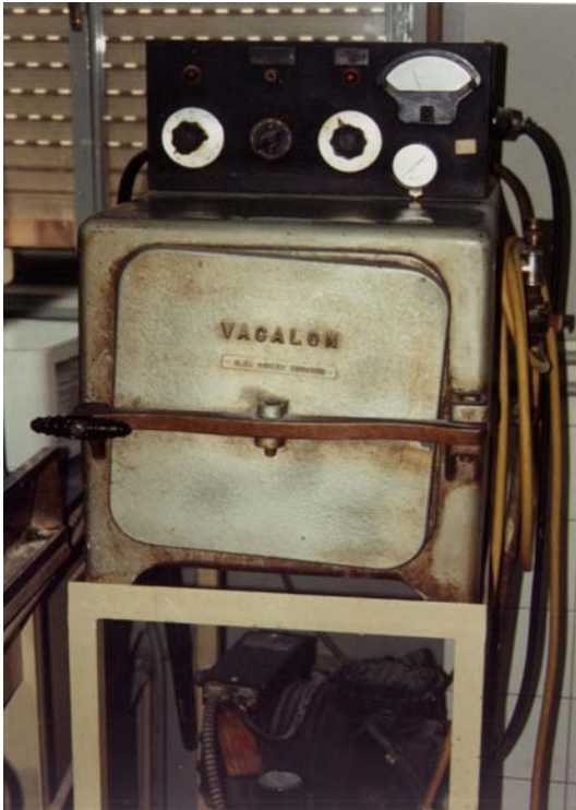
Imagen 8. Máquina de electrovacío necesaria para la polimerización de la resina Vacalon®.
