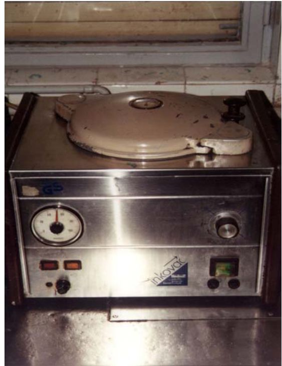
Imagen 9. Máquina de temperatura y presión para la polimerización de PMMA de vertido.
