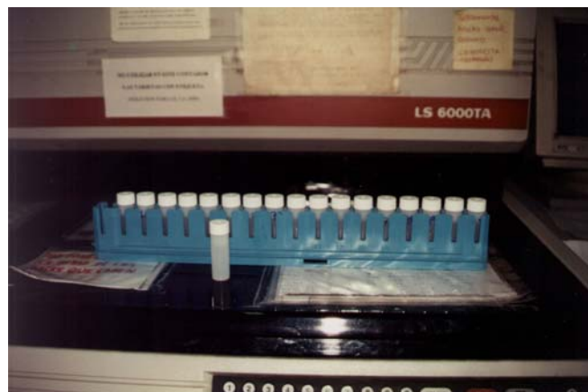
Imagen 10. Detalle de gradilla y tubos para depositar las muestras de PMMA y realizar recuento en cámara de centelleo.
