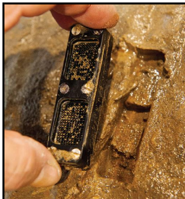
Imagen 1. El iChip es un dispositivo en miniatura, desarrollado por el equipo de Slava Epstein, el cual permite aislar y crecer células individuales en su entorno natural y, por lo tanto, proporcionar a los investigadores un mejor acceso a las bacterias de difícil cultivo. El iChip se utilizó para encontrar la teixobactina. Foto cortesía de Slava Epstein, Northeastern University, Boston, MA 5 .
