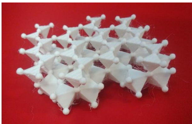
Figura 1: estructura tridimensional de la caolinita. Los tetraedros son los poliedros de coordinación del silicio, los octaedros son los poliedros de coordinación del aluminio y las esferas los átomos de oxígeno.
