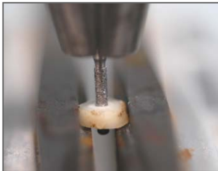
Foto 4: Perforación de la sección de raíz
